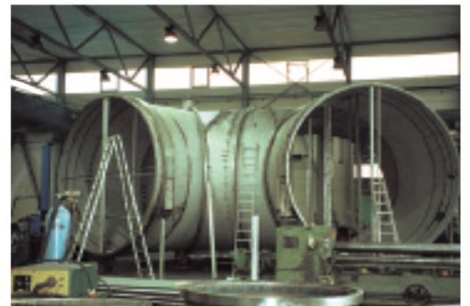
Hosenstück für den Kraftwerksbau/ Y-piece for power plant
