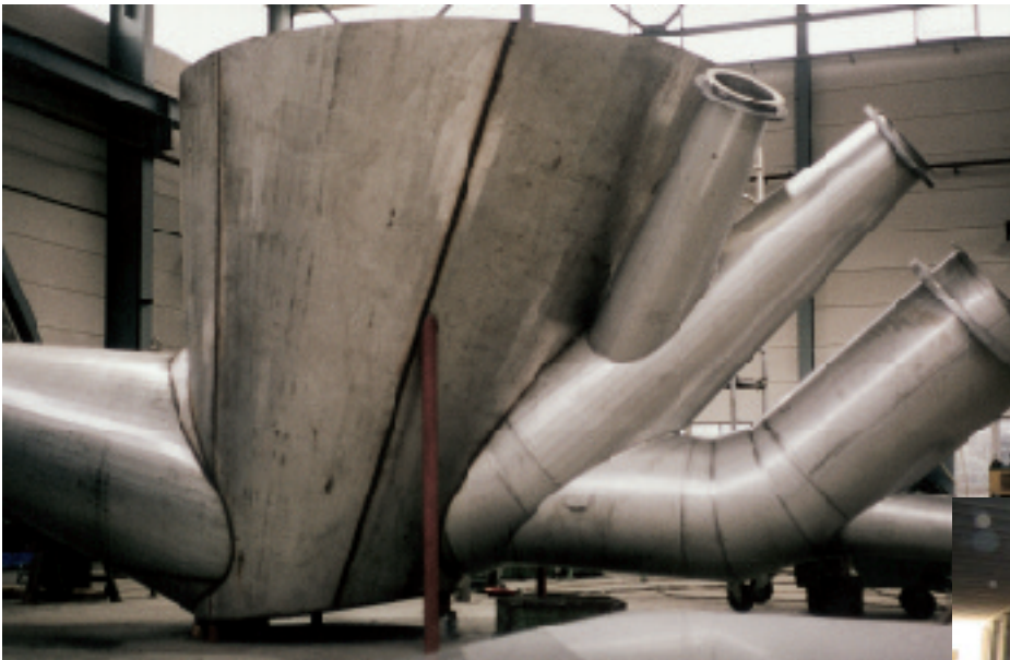
Behälterunterteil mit Stutzen/ Bottom part of vessel with welded in-outlets
