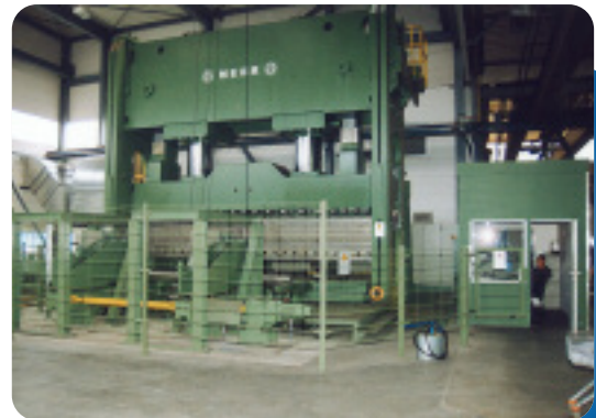
Presse 4000t Rohre bis 6000 mm Läng, bis 50 mm Wandstärke/press 4000t pipes l = 6000 \text{ mm} , t = 50 \text{ mm}
