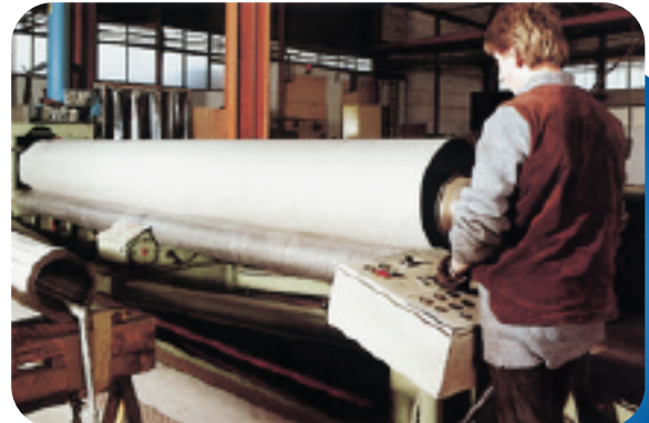
Ein- und Rundwalzen von Rohren L = 6000 \text{ mm} , S = 15 \text{ mm} Roll Forming, L = 6000 , t = 15 \text{ mm}
